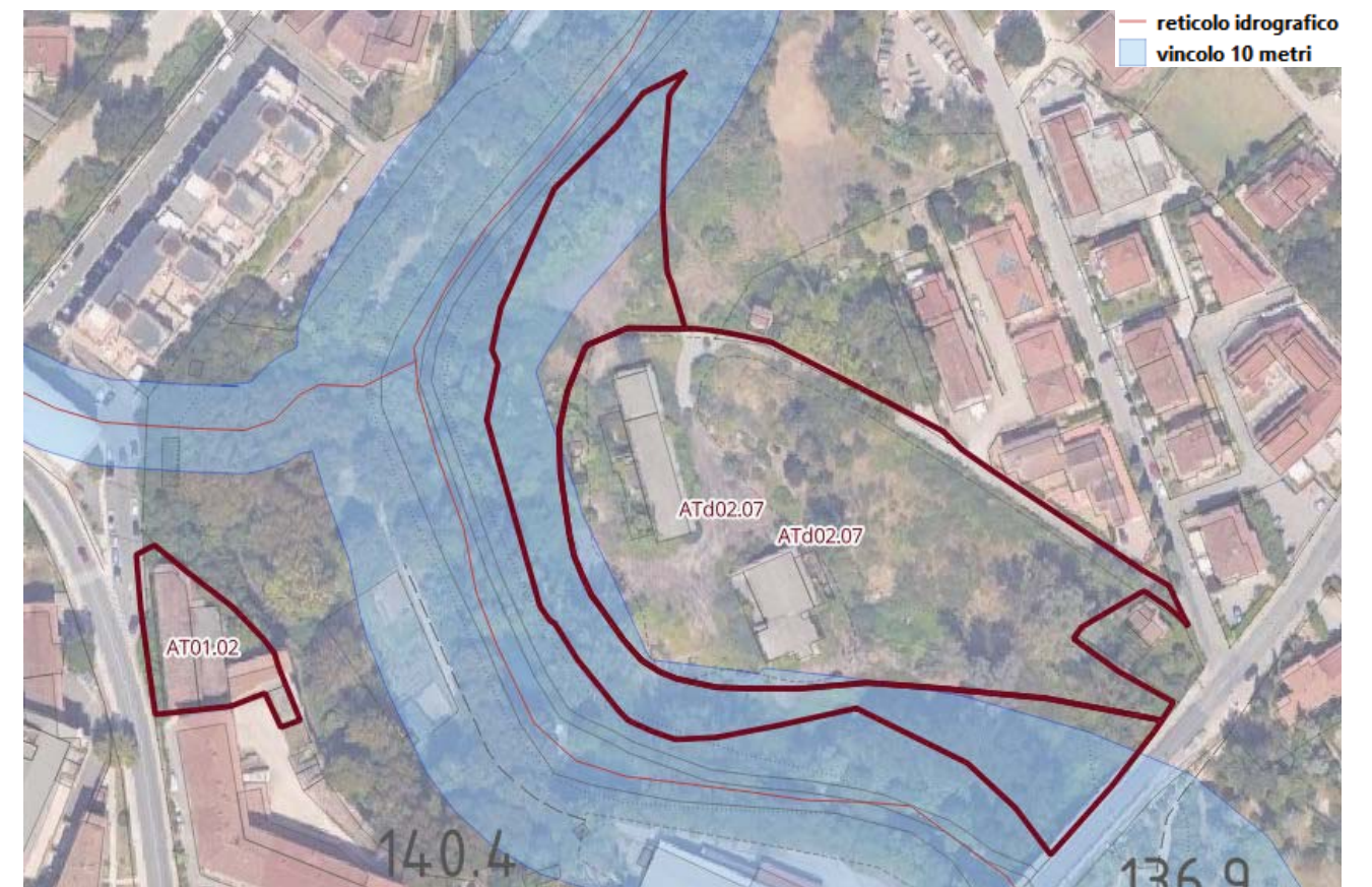
Figura 4 - Asta del reticolo idrografico regionale e vincolo dei 10 m dal ciglio di sponda (Art. 3 LR 41/2018)
