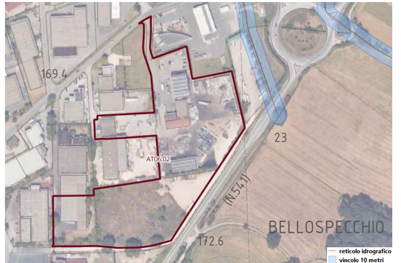
Figura 4 - Asta del reticolo idrografico regionale e vincolo dei 10 m dal ciglio di sponda (Art. 3 LR 41/2018)
