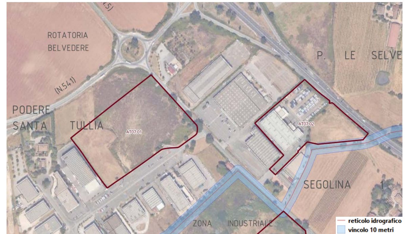
Figura 4 - Asta del reticolo idrografico regionale e vincolo dei 10 m dal ciglio di sponda (Art. 3 LR 41/2018)
