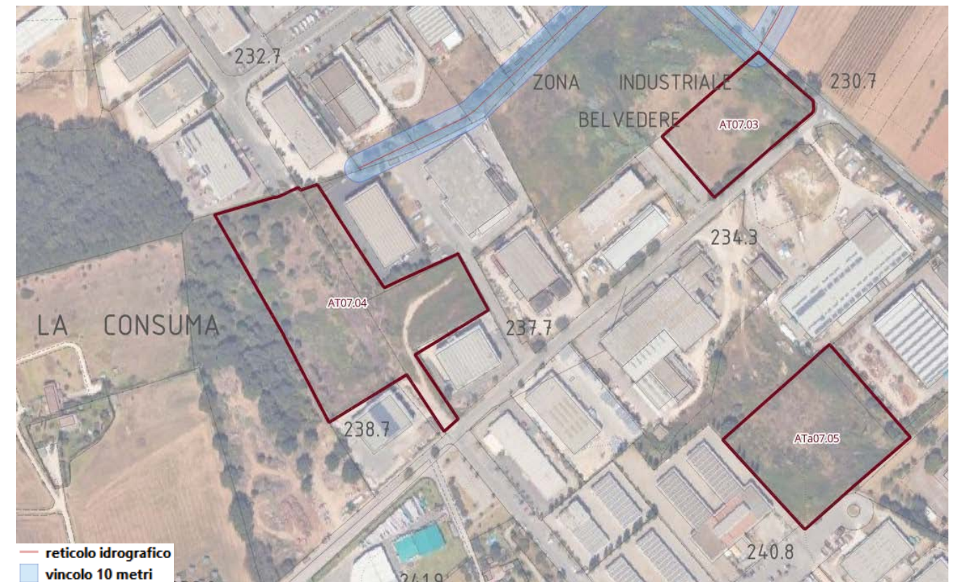
Figura 4 - Asta del reticolo idrografico regionale e vincolo dei 10 m dal ciglio di sponda (Art. 3 LR 41/2018)
