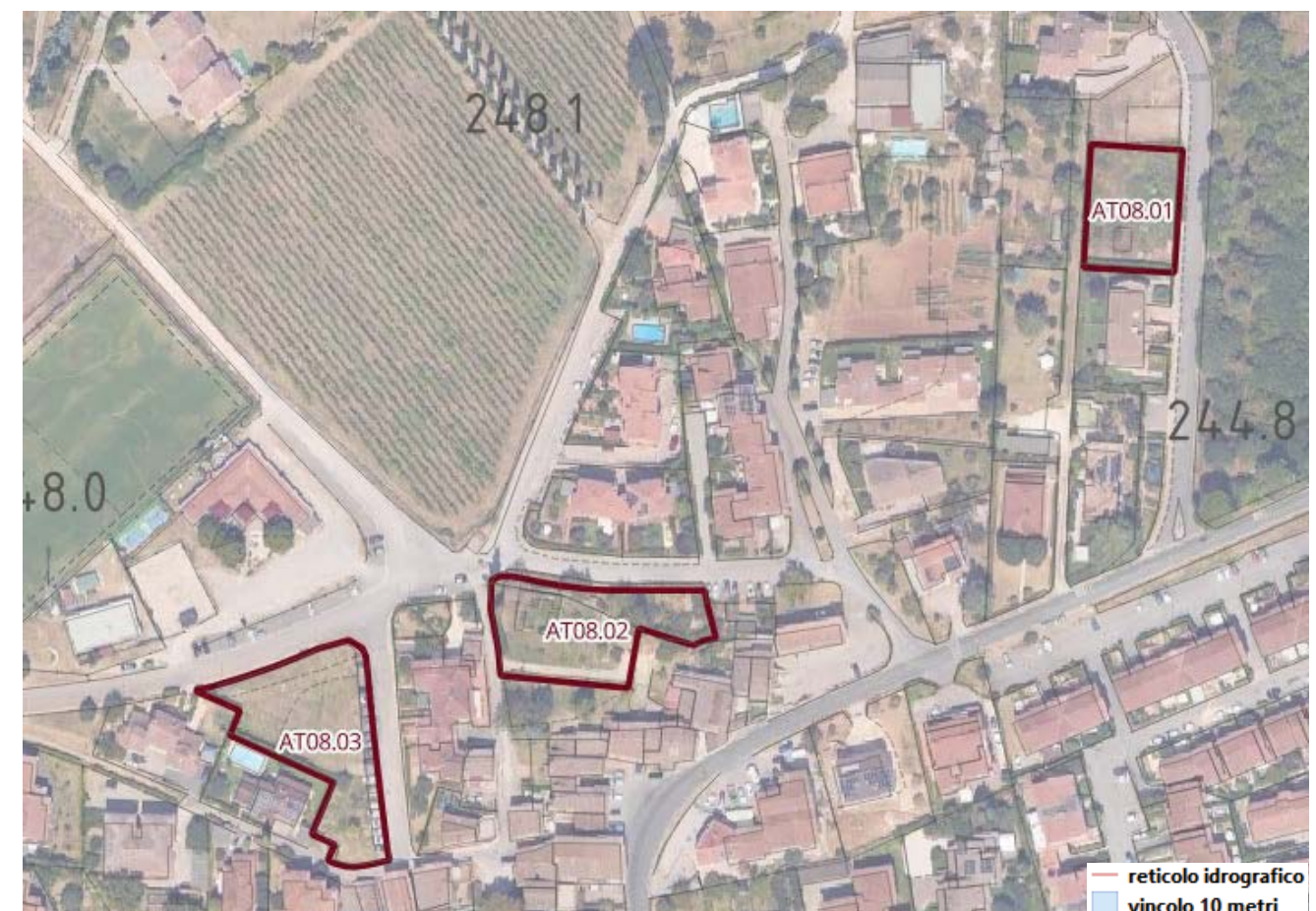
Figura 4 - Asta del reticolo idrografico regionale e vincolo dei 10 m dal ciglio di sponda (Art. 3 LR 41/2018)
